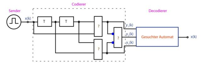
Das ursprüngliche Sendesignal x(k) soll mittels eines Decodierers aus dem Empfangssignal  $(y_1(k), y_2(k), y_3(k))$  fehlerfrei rekonstruiert werden.
