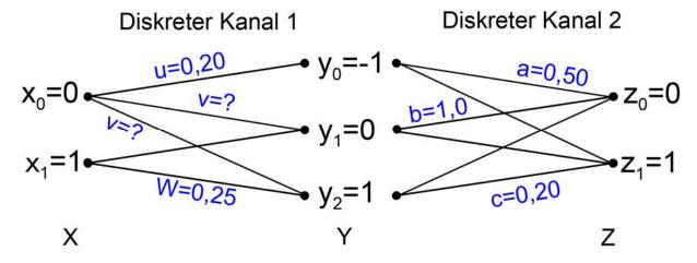
Die beiden Kanäle werden rückwirkungsfrei in Kette geschaltet und der erste Kanal (Kanal 1) wird von der **gedächtnislosen** Quelle X gespeist!
